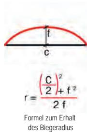
Für gewölbte Strukturen können die Profile Genus mit Mikroknickbiegungen und einem Radius nach Wunsch ab 600 mm gebogen werden, ausschließlich der Profile Comet, Genus 60, 73 und 160.
