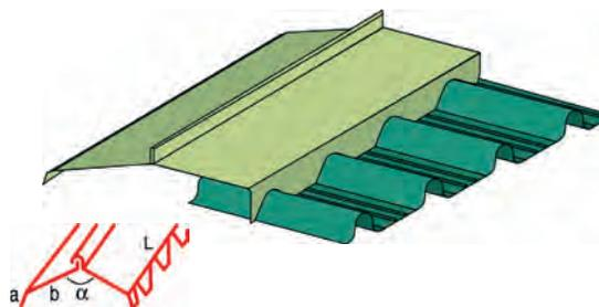
Questo elemento permette di raccordare gli elementi pressopiegati, negli sviluppi richiesti a disegno, con i profili delle coperture grecate. Le sovrapposizioni saranno fissate con sigillanti e rivetti.
